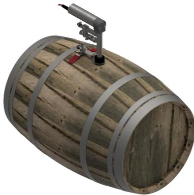
Das Handgerät BRA Flex PR.000.031 zur Fassreinigung am Lagerplatz mit elektrischem Antrieb besteht aus einem Reinigungskopf, einem Elektromotor und einem Verbindungsrohr mit flexiblem Saugfuss.
